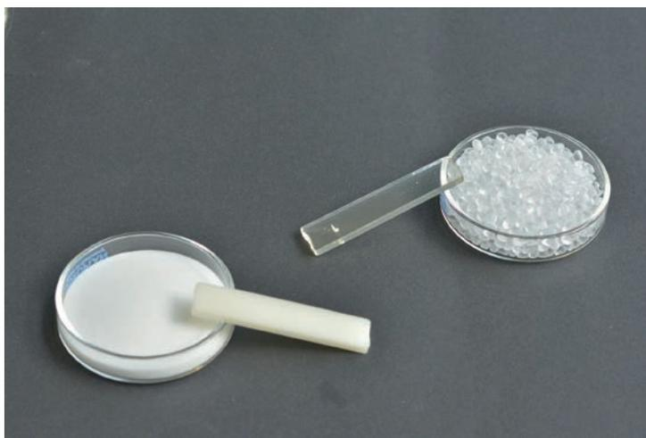
**Abb. 16a** Schalen mit den für die Herstellung der Nanokomposite verwendeten Ausgangsmaterialien: CNC (links im Bild, zusammen mit einem mit CNC hergestellten Prüfkörper) und Polyvinylalkohol (PVA, rechts im Bild, zusammen mit einem Prüfkörper aus reinem PVA).
