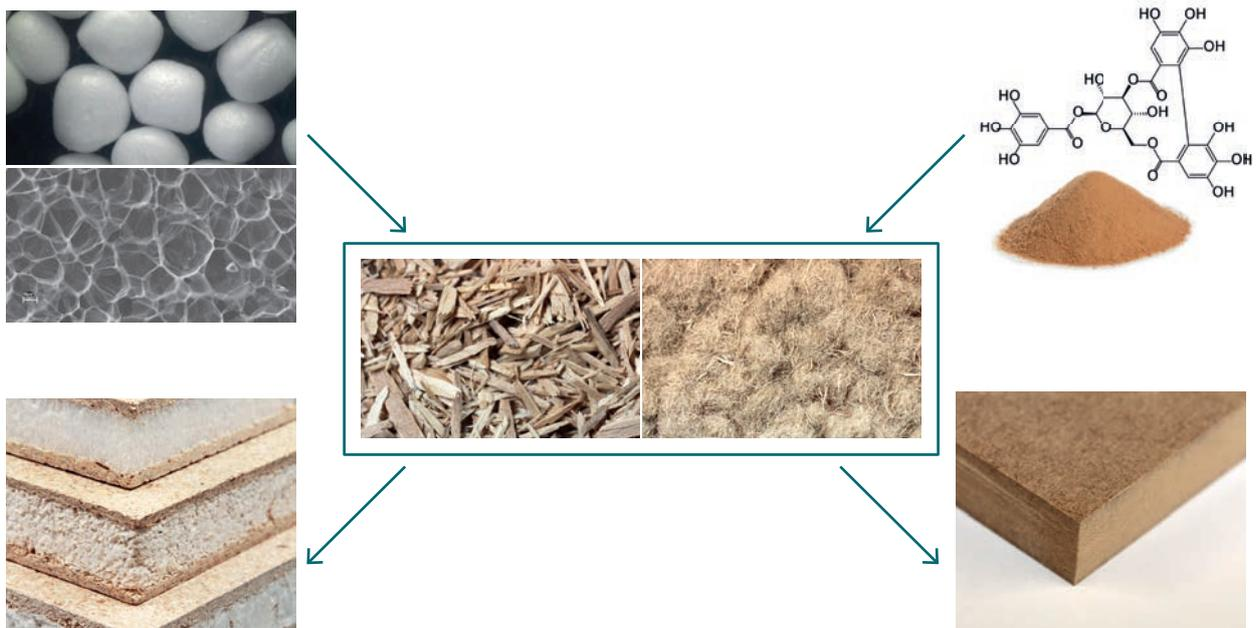
Abb. 11 Die Forschung im Bereich Holzwerkstoffplatten (Span/Faser) zielt auf leichtere Platten mit porösen Schaumkernen in der Mittellage und auf die Etablierung biobasierter Klebstoffe (Dank an Heiko Thoemen).
