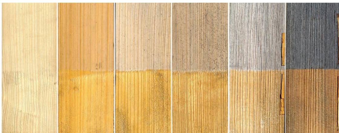
**Abb. 10b** Das Bewitterungsverhalten von Fichteplatten im Verlauf eines Jahres bei einer Exposition Süd, 45° geneigt. Die Proben sind im unteren Teil gereinigt, was zu einer delignifizierten, homogenen Oberfläche führt.
