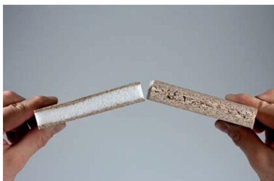
**Abb. 12b** Neu entwickelte Schaumkernplatte (links) im Vergleich zur konventionellen Spanplatte.
