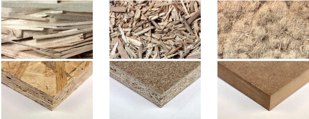
**Abb. 3** Ausgangsmaterialien wie Holzspäne oder Holzfasern können zu Holzwerkstoffplatten mit unterschiedlicher Struktur und unterschiedlichen Eigenschaften verarbeitet werden. Bilder links: OSB-Platte und zugehörige Späne; Bilder Mitte: herkömmliche Spanplatte und zugehörige Späne; Bilder rechts: MDF Platte und zugehörige Fasern (Dank an Heiko Thömen).
