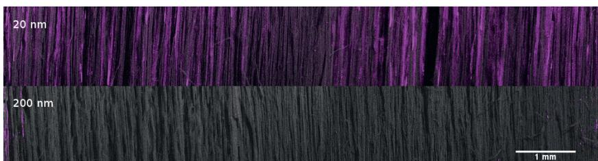
**Abb. 8c** Analyse der Verteilung von Nanopartikeln im Kiefernholz mittels energiedispersiver Röntgenspektroskopie. In den mit pinker Farbe gekennzeichneten Regionen befinden sich Siliziumdioxid-Nanopartikel
